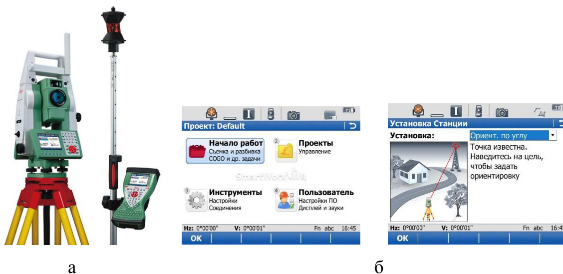
Рис. 1. Электронный тахеометр Leica Viva TS15P с полевым контроллером Leica Viva CS10 и отражателем 360° Leica GRZ122 (а) и программное обеспечение SmartWorx Viva (б)
